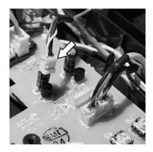
20. PLUG IN 3PIN USB CABLE INTO NO SOLDER BOARD.
